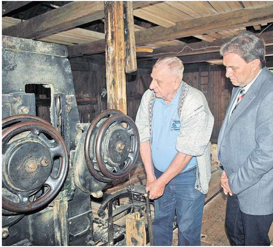
Der erste Schneidmüller Bernhard Schlee erklärt Mühlvogt und Landrat Klaus Löffler das königlich-bayerische Eisenvollgatter.
